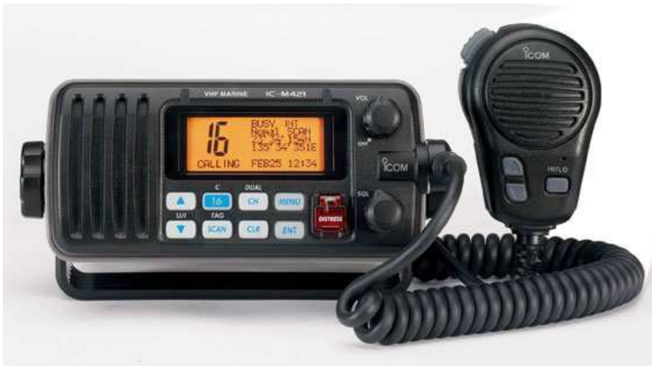
Resim 4: 16. Kanala ayarlanmış VHF telsiz
